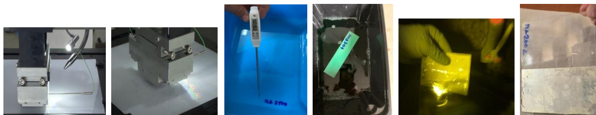
Fig. 1. Instalația pentru imprimarea mărcii holografice și câteva detalii din procedura de electroformare și depunerea Ag coloidal
